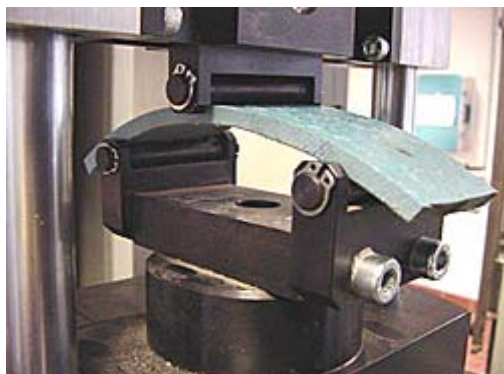
a) 3-Punkt-Biegeversuch nach DIN EN ISO 178
