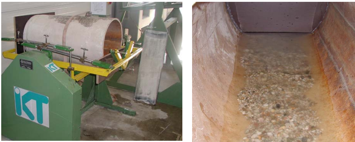
Bild 8: a) Linerprobe in der „Darmstädter Kipprinne“; b) Zuschlagstoff
