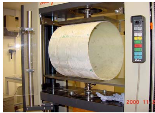
b) Kurzzeit-Scheiteldruckversuch nach DIN EN 1228
