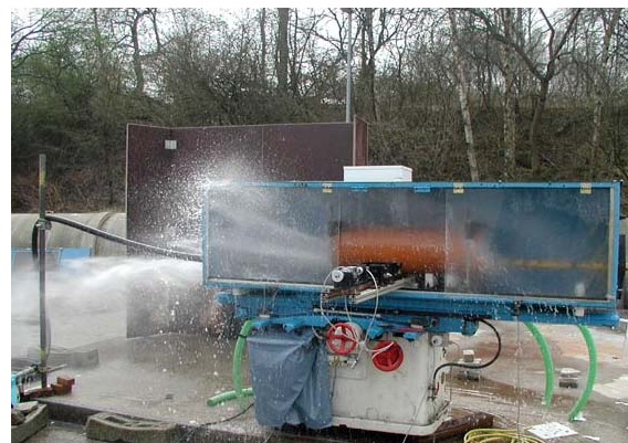
b) Schwenktisch mit Liner wird 50 x entlang der Düse bewegt
