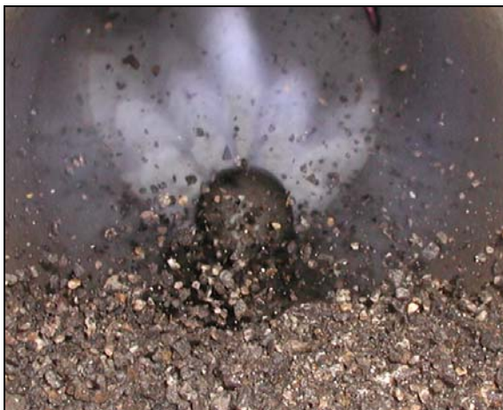
Bild 10: Prüfgeschiebe, Splitt (1-5 mm)
