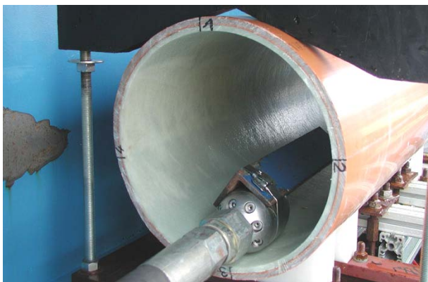
a) Prüfdüse wird in das Rohr geführt
