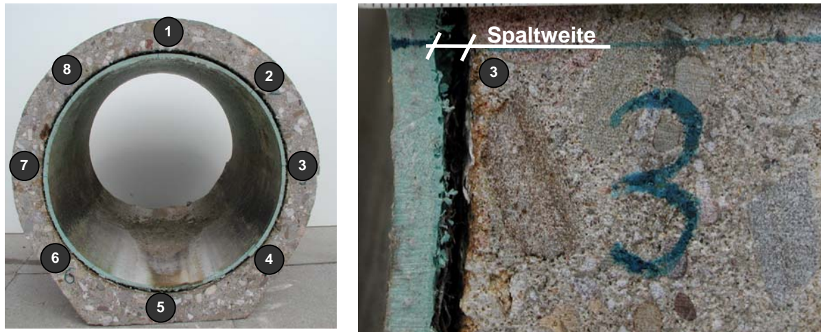
Bild 4: Vermessung der Ringspaltweiten in den Achtelspunkten
