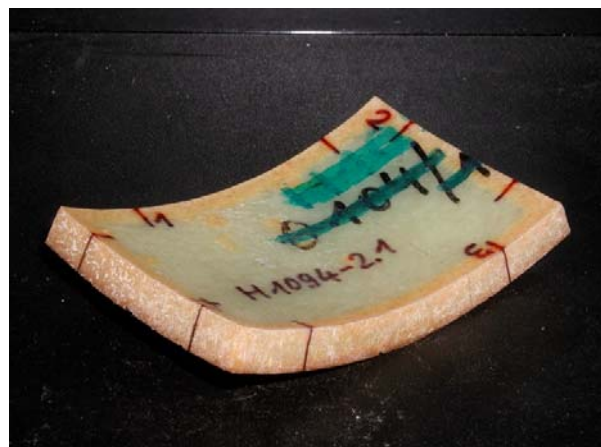
Bild 32: Materialveränderung: Ansicht einer Linerprobe vor und nach der Einlagerung
