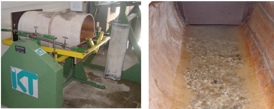
Bild 25: a) Linerprobe in der „Darmstädter Kipprinne“; b) Zuschlagstoff
