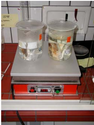
Bild 31: Eingelagerte Linerproben auf Heizplatte
