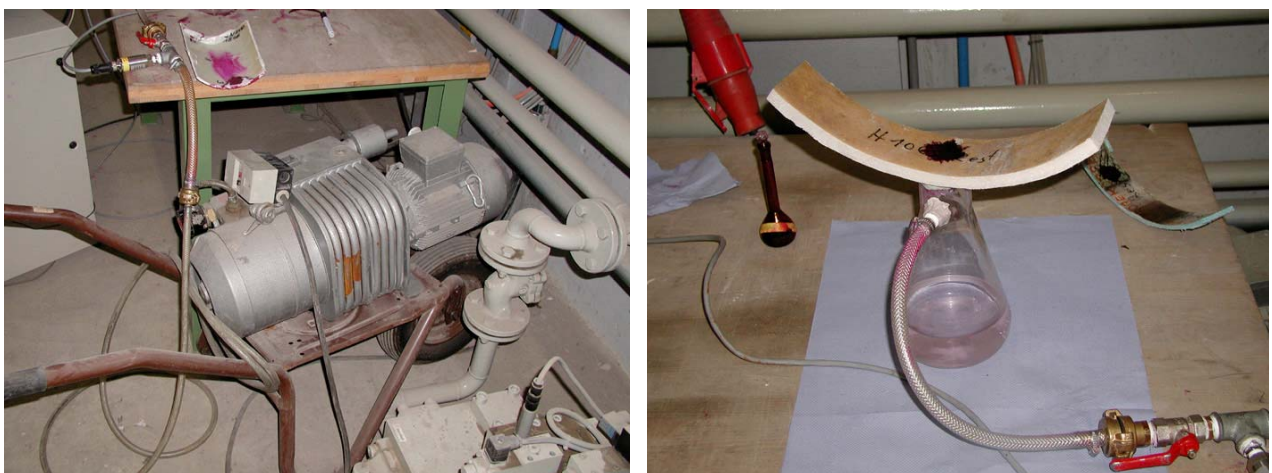
Bild 49: Vakuumpumpe; Linerprobe mit Prüfliquidität
