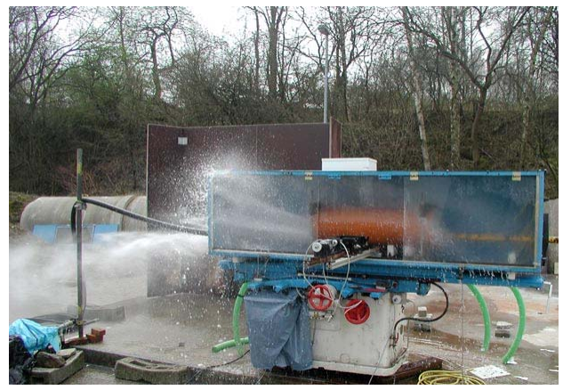
d) Liner wird 50 x entlang der Düse bewegt
