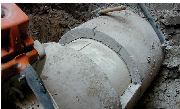
Bild 6: Entnahme von Probekörpern aus in Betrieb befindlichen Haltungen, Beispiel
