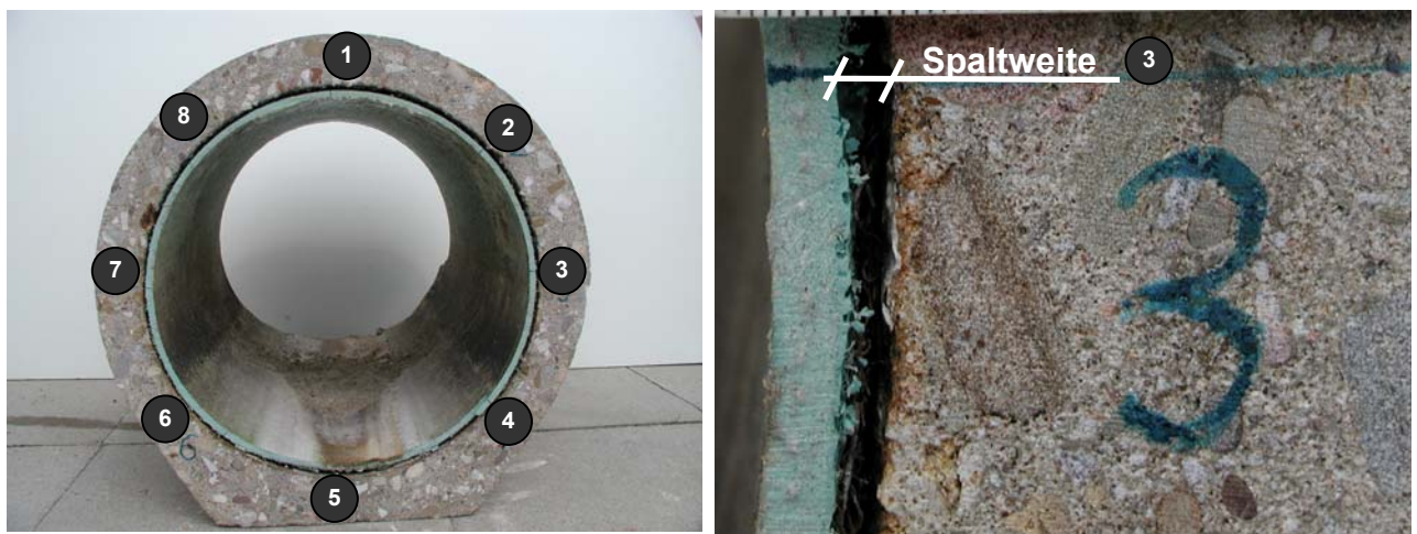
Bild 12: Vermessung der Ringspaltweiten in den Achtelpunkten
