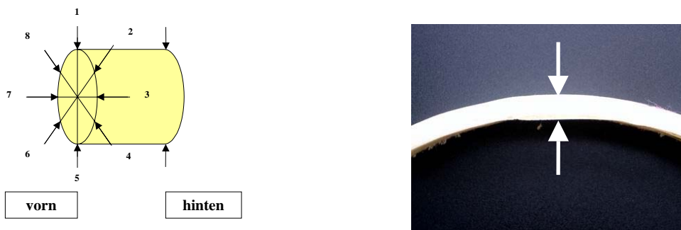
Bild 7: Wanddickenverteilung über den Umfang, 16 Messpunkte
