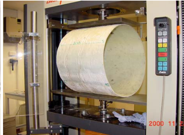
Bild 20: Prüfungen zur Bestimmung von Biegefestigkeit und E-Modul
