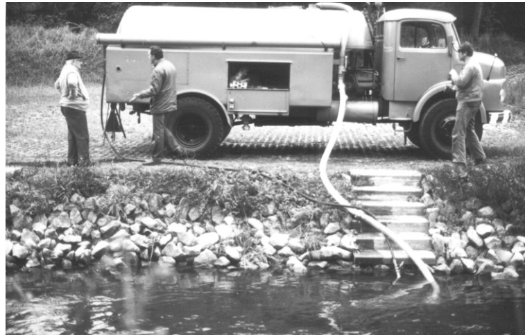
Abbildung 18: Befüllen eines Hochdruckreinigungsfahrzeuges über einen Filterejektor mit Wasser aus dem Fluss Leine, 1982
