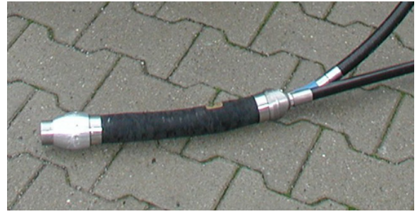
Abb. 2: Göttinger-ZK-Kanalwurm 50 mm Durchmesser mit Hochdruck-Spüleinsatz
