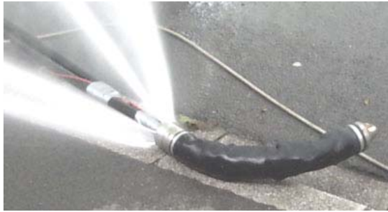
Abb. 1: Göttinger-ZK-Kanalwurm 70 mm Durchmesser mit Hochdruck-Spüleinsatz
