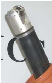
Abb. 3: Hausanschluss-Prüfsystem SIDAL: Packersystem mit abzweigendem Kanalwurm (links), Kanalwurm mit Dreh-Schwenkkopf (Mitte), Funktionsskizze SIDAL [3] (rechts)
