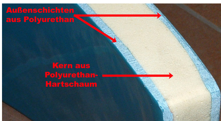
Abb. 4: Aufbau einer Polyurethan-Sandwich-Beschichtung
