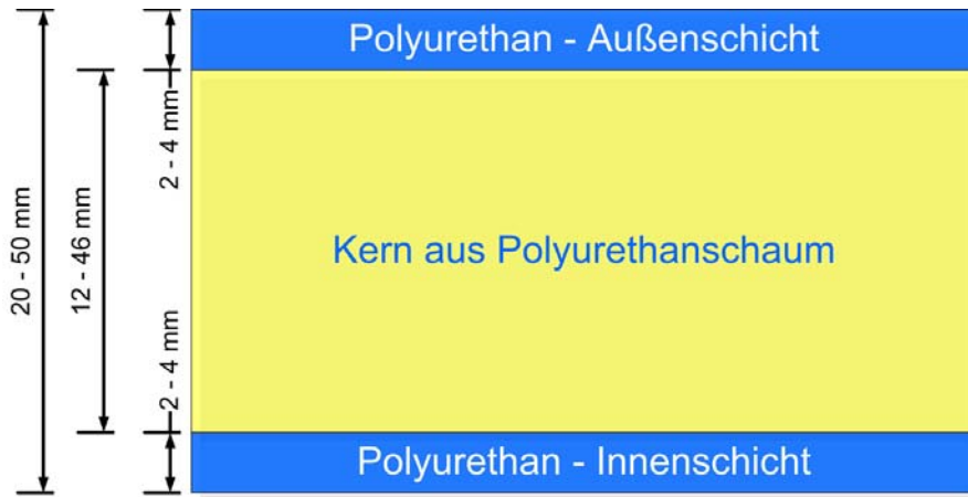
Abb. 8: Bau- und betriebstechnisch sinnvolle Querschnitte der Sandwich-Beschichtung
