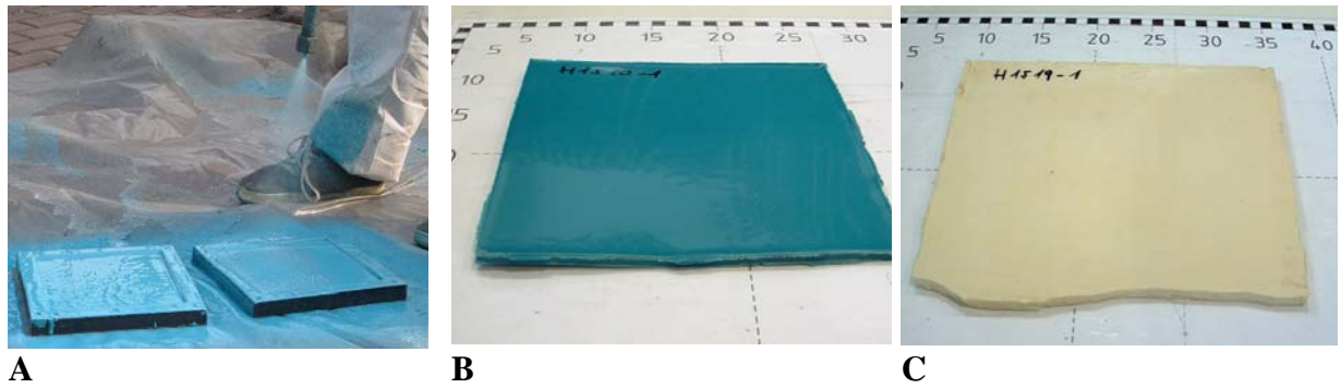
Abb. 12: Ausgangs-Probekörper für die Überprüfung der Materialkennwerte der Einzelkomponenten des Sandwich-Querschnitts. A: Herstellung von Polyurethan-Platten im Aufspritzverfahren. B: Erhärtete und entschaltete Polyurethan-Platte. C: Erhärtete und entschaltete PUR-Hartschaum-Platte.
