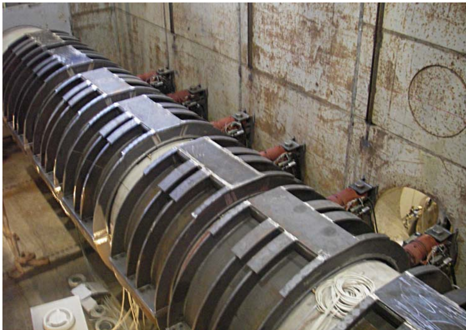
Bild 11 IKT-Vortriebssimulator: DN 1600, d_a = 2100 mm, L_{\text{Rohr}} = 16 m
