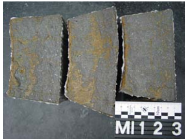
Abb. 12: Serie Schacht 5 nach 28 FTW in 3%igeer NaCl-Lösung
