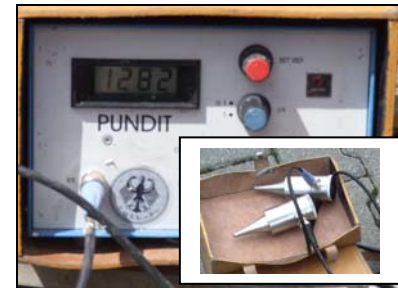
Abb. 7: Ultraschallmessgerät mit Sender und Empfänger
