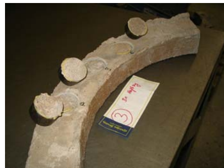
Abb. 18: Haftzugprüfungen an ausgebauten Kreissegmenten
