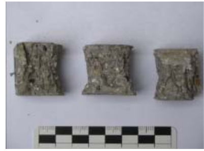
Abb. 11: Mörtelfuge mit darunter liegendem Ausgleichsring
