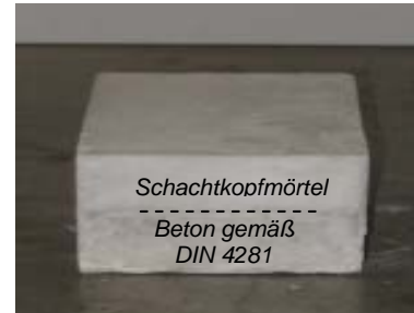
Abb. 14: Verbundprobekörper (Seitenansicht) nach Herstellung
