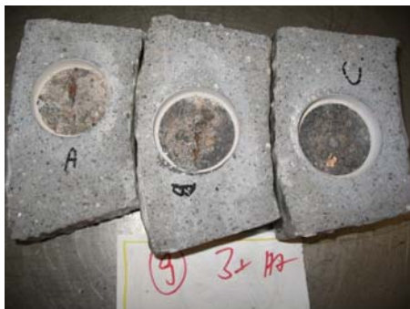
Abb. 17: Haftzugprüfungen an bewitterten Probekörpern
