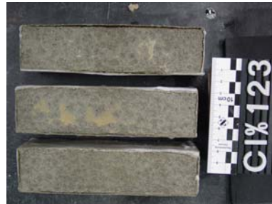
Abb. 13: Serie Schacht 9 Mörtel C nach 28 FTW in 13%iger NaCl-Lösung
