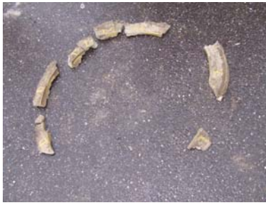
Abb. 9: Markierte Bruchstücke einer Mörtelfuge
