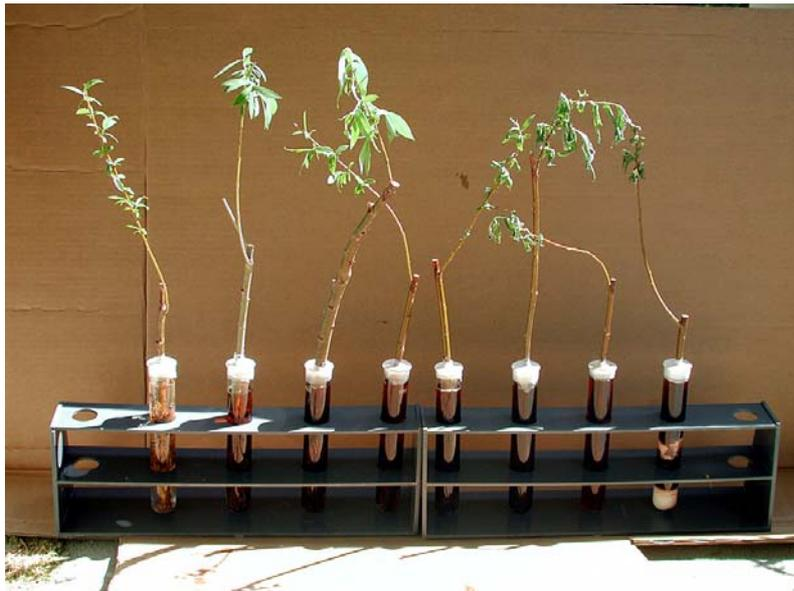
**Abb. 8:** Versuchsaufbau zur Ermittlung des Erfolges von Verfahren zur chemischen Wurzelentfernung.
