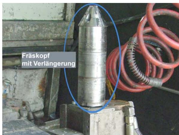
Abb. 13: Zur Entfernung von Wurzelpolstern im Einmündungsbereich der Anschlussleitungen (Abzweige) wurde ein Fräskopf mit einer Verlängerung eingesetzt.
