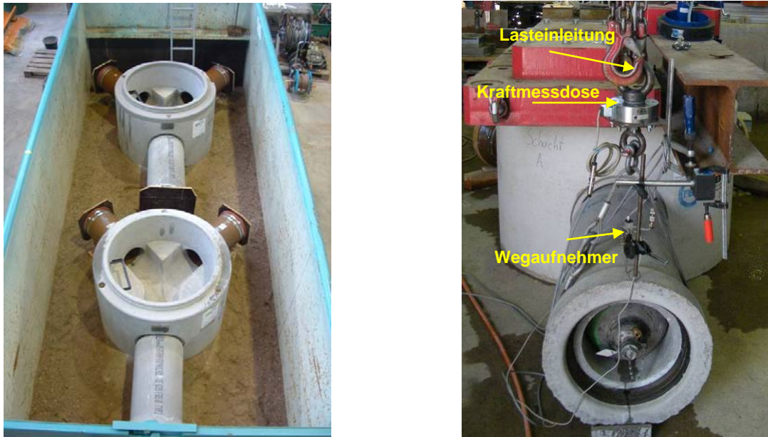
Bild 14 Versuchsaufbau für die einzelnen Sanierungen vor Bodenverfüllung (links); Versuchsaufbau für die Abwinkelung (rechts)
