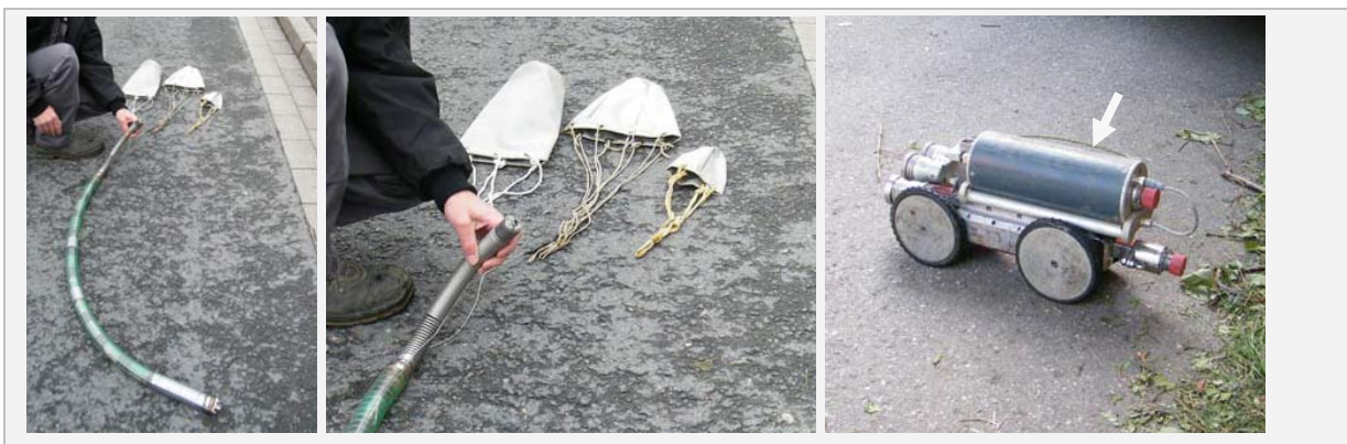
Abb. 9: Schleppkamera – Axialkamera mit Saugschirm (li, mi) und Radarantenne auf Kamerafahrgewagen (re)
