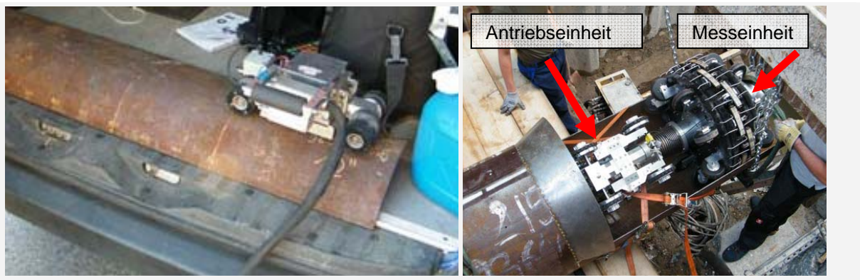
Abb. 10: Wirbelstromprüftechnik zur Außen-Inspektion (li) und Inspektionsroboter mit Wirbelstromprüfeinheit zur Innen-Inspektion (re)
