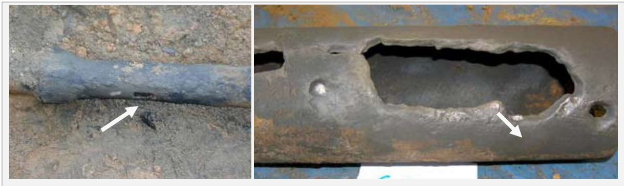
Abb. 5: Lochkorrosion in einer Grauguss-Abwasserdruckleitung (links) [14] und graphitisiertes Trinkwasser-Graugussrohr (rechts) [9]
