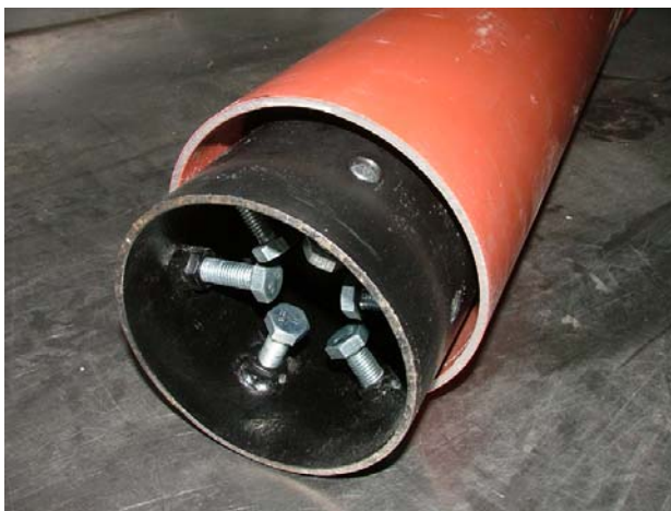
Abb. 10: A Stützvorrichtung zur Vermeidung von Formveränderungen (Beulen) während der Untersuchung von Kunststoffrohren (nicht eingebaut, nicht verspannt). B: Schema der Innendruckprüfanlage mit einem eingebauten Prüfkörper mit Stützvorrichtungen (grau).
