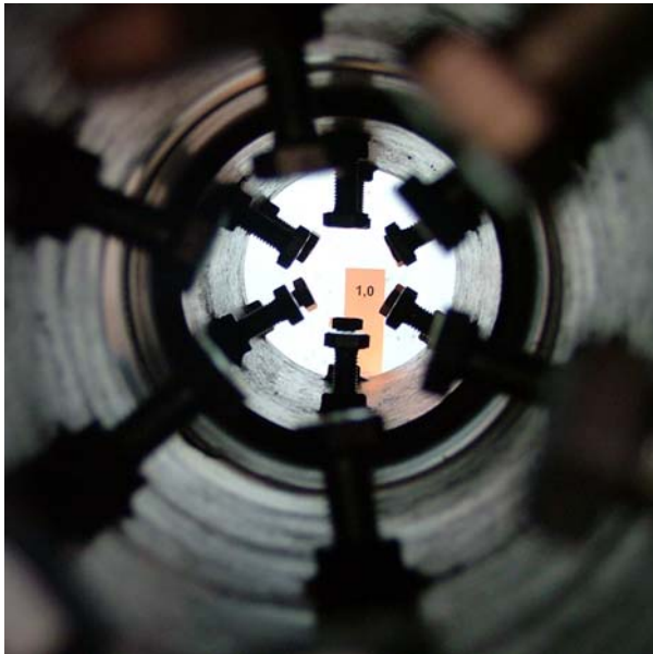
Abb.11: Rohrverbindung Rehau AWADUKT PP SN 10 RAUSISTO DN 160, bei einem Außenüberdruck von 1,0 bar . Kein Wassereintritt.
