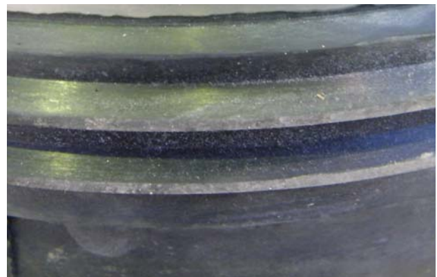
Abbildung 6: Dichtlippen der Manschette H2077-2, Prüfstrecke 1
