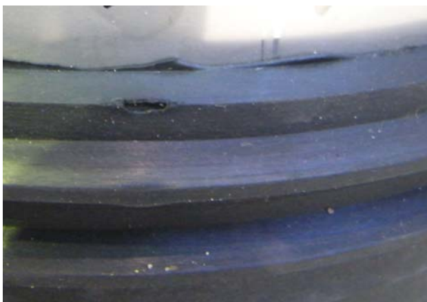
Abbildung 7: Veränderung am Elastomer-Ende der Manschette H2077-1, Prüfstrecke 2
