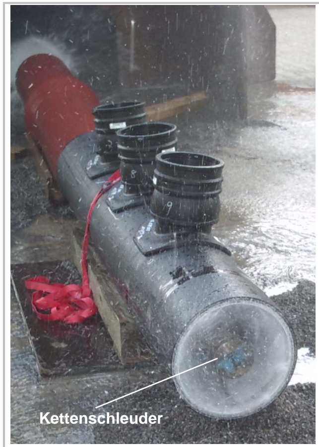
Abb. 7: Versuchsaufbau und Einsatz der Kettenschleuder
