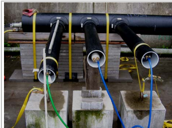
Versuchsaufbau zur Abwinkelung der Anschlussleitungen
