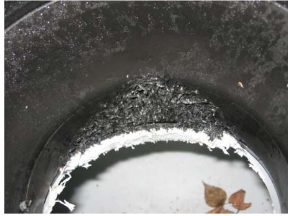
Abb. 9: Veränderungen nach Einsatz der Kettenschleuder
