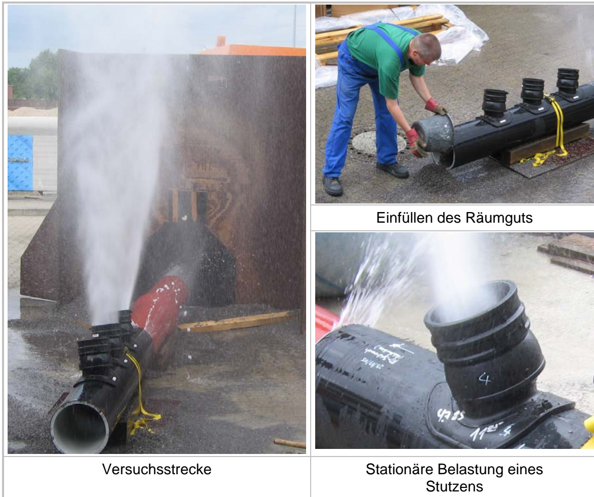
Abb. 6: Versuchsaufbau- und Durchführung der Hochdruckreinigung
