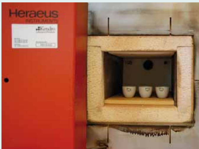
Bestimmung von Füllstoff und Glasgehalt
