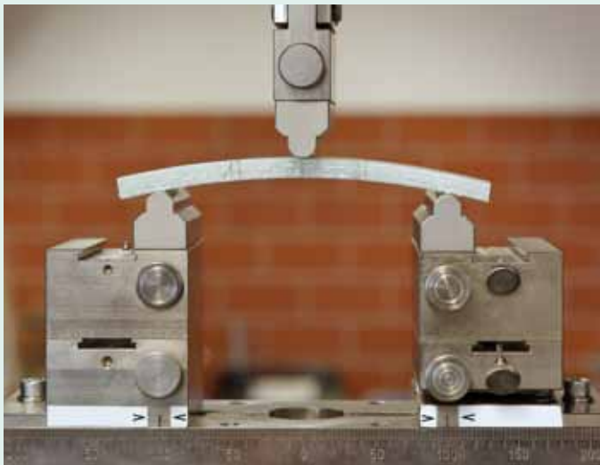
Drei Punkt Biegeversuch nach DIN EN ISO 178
