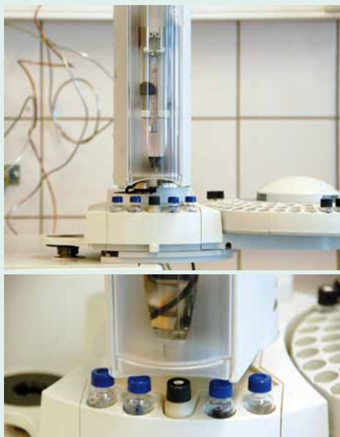
Bestimmung des Reststyrolgehaltes nach DIN 53394-2
