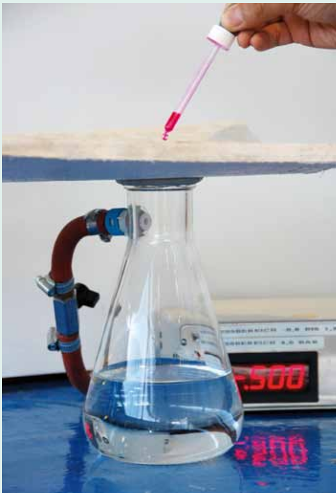
Dichtheitsprüfung der Materialprobe des Liners
