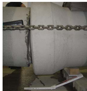
Bild 2 Prüfungsdurchführung: Verschluss Spitzendseite (links); Verschluss Muffenseite (Mitte); Abwinkelung in der Rohrverbindung (rechts)
