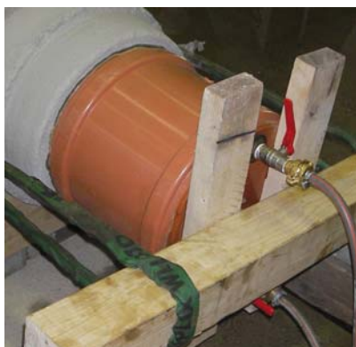
Bild 2 Prüfungsdurchführung: Verschluss Spitzendseite (links); Verschluss Muffenseite (Mitte); Abwinkelung in der Rohrverbindung (rechts)
