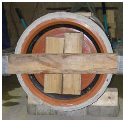
Bild 2 Prüfungsdurchführung: Verschluss Spitzendseite (links); Verschluss Muffenseite (Mitte); Abwinkelung in der Rohrverbindung (rechts)
