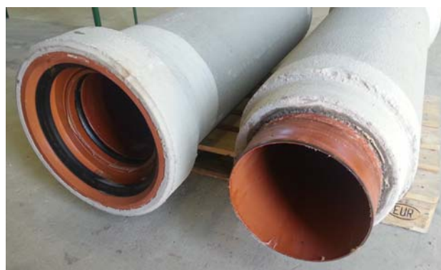
Bild 1 „Fabekun-Rohre DN 300“: Ansicht (links); Muffe und Spitzende (rechts)
