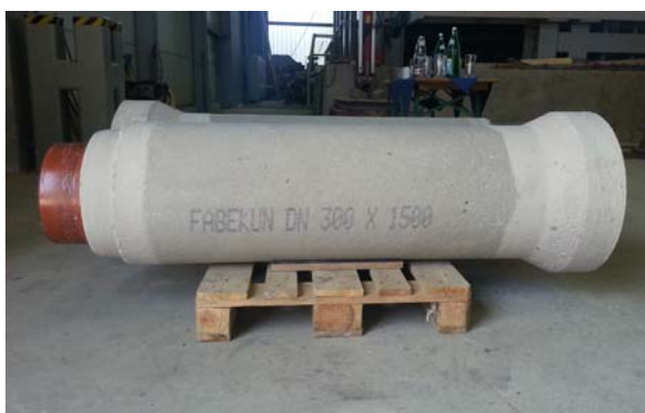
Bild 1 „Fabekun-Rohre DN 300“: Ansicht (links); Muffe und Spitzende (rechts)
