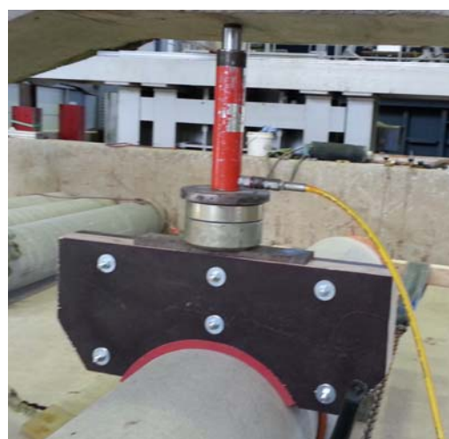
Bild 2 Prüfungsdurchführung: Versuchsaufbau (links); Scherlasteinleitung mit Hydraulikzylinder (rechts)
