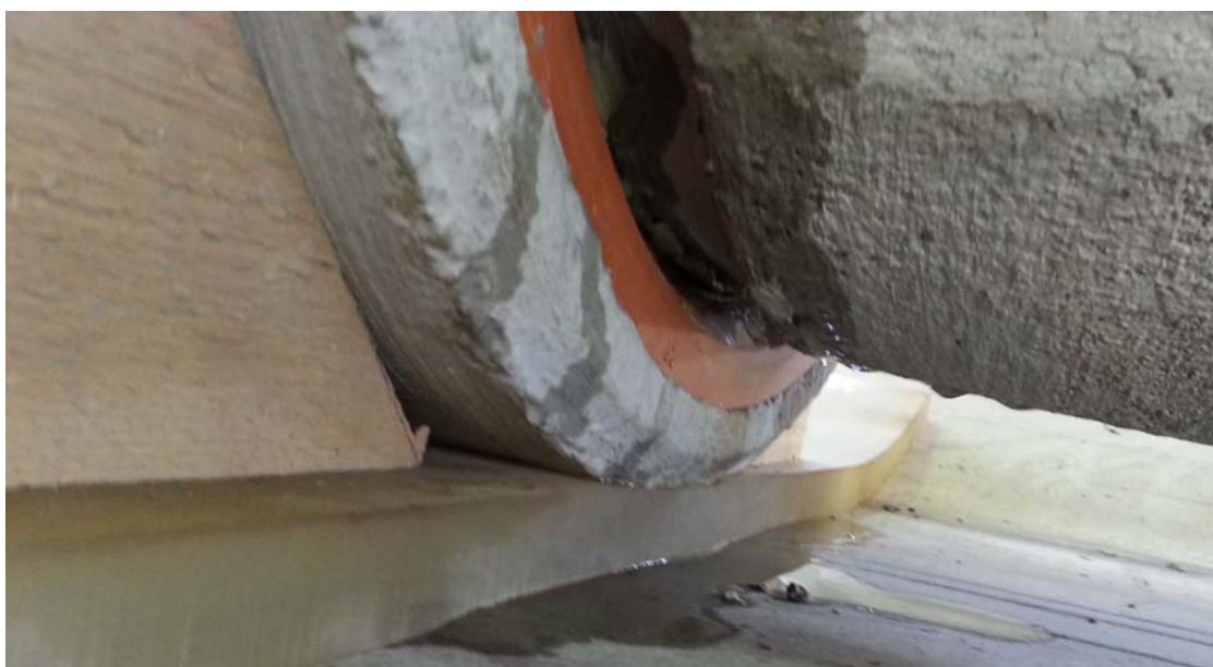
Bild 3 Prüfungsdurchführung: Undichtigkeit bei einer Scherlast von 35 kN
