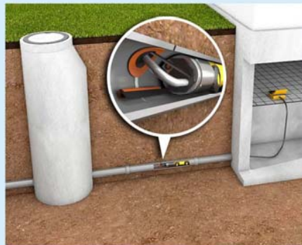
Roboterverfahren z.B. Injektion, Verpressen, Verspachteln (nur bedingt einsetzbar, da i.d.R. erst ab DN 200 möglich)
