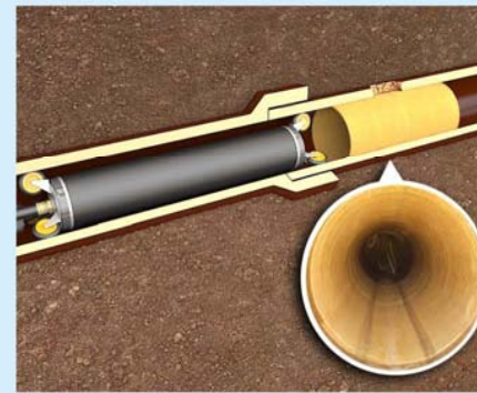
(c) Reparatur mit Kurzlinern Blick in die sanierte Leitung
