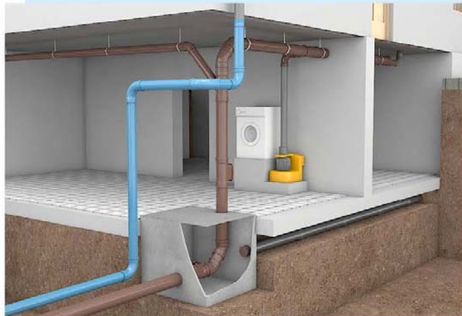
Abhängen neuer Leitungen im Kellerbereich
