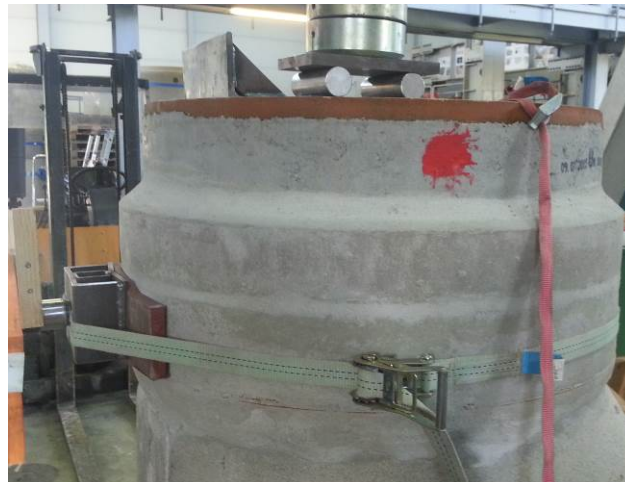
Bild 9 System mit Adapterring: kein Versagen der Fugen Konus-Adapterring-Schachtrahmen bei 132 KN (links) sowie der Fugen Konus-Adapterring-Ausgleichsringe-Schachtrahmen bei 132 KN (rechts)
