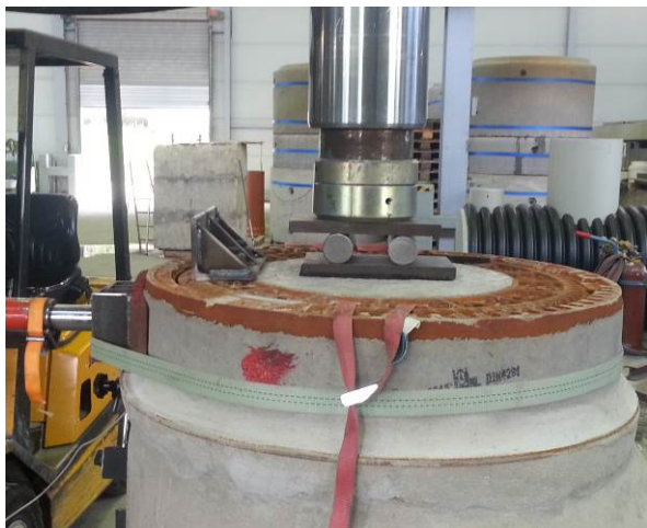
Bild 9 System mit Adapterring: kein Versagen der Fugen Konus-Adapterring-Schachtrahmen bei 132 KN (links) sowie der Fugen Konus-Adapterring-Ausgleichsringe-Schachtrahmen bei 132 KN (rechts)
