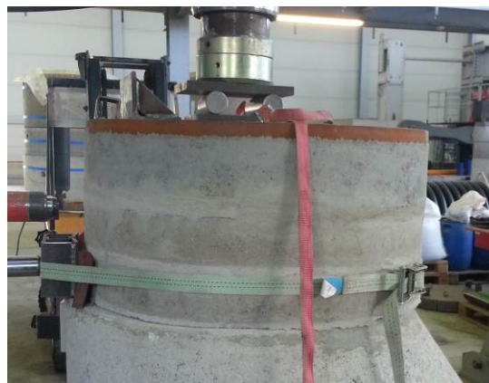
Bild 7 System ohne Verschiebesicherung: Scherbruch in der Fuge Konus-Schachtrahmen i.M. bei 55 KN (links) und Scherbruch in der Fuge Konus-Ausgleichsring i.M. bei 80 KN (rechts)
