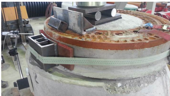
Bild 8 System mit Verschiebesicherung: Scherbruch in der Fuge Konus-Schachtrahmen bei i.M. 90 KN (links) und Kein Versagen der Fuge Konus-Ausgleichsring bei 132KN (rechts)
