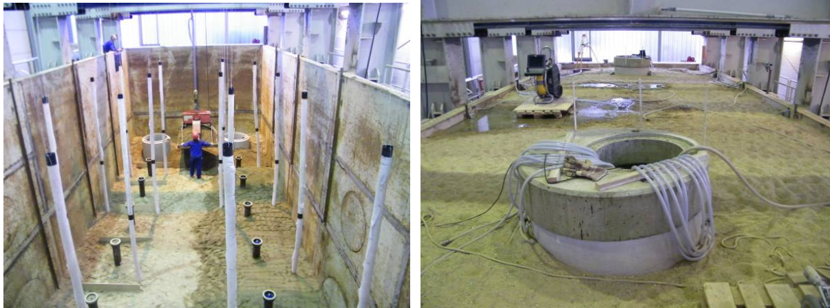
Bild 4 Versuche an linersanierten Hauptkanälen: Versuchsaufbau (links) und komplett hergestellter Versuchsaufbau (rechts)
