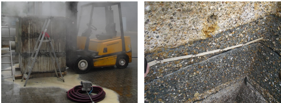
Bild 3 PNEUCOMAT-Wasserfräse: Versuchsaufbau während des Strahlvorgangs (links) und Ergebnis des Strahlens (rechts)
