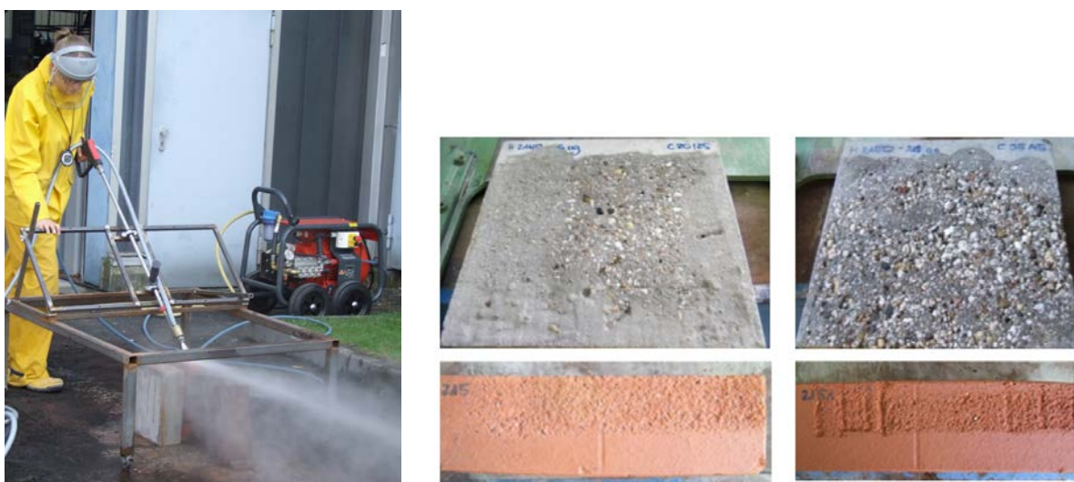
Bild 2 Händisch durchgeführte Stahlversuche: Versuchsdurchführung (links) und exemplarische Versuchsergebnisse an Beton und Mauerwerk (rechts)
