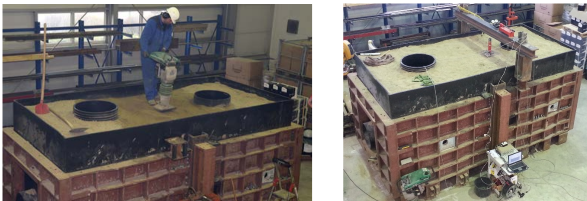
Bild 9 Versuchsaufbau im mittelformatigen Versuchsstand zur Simulation von LKW-Vorbeifahrten: Verdichtung des Bodens mit Rüttelplatte (links); Fertig aufgebauter Versuchsstand mit Einrichtung zur Lasteinleitung und Messwerterfassung im Vordergrund (rechts)
