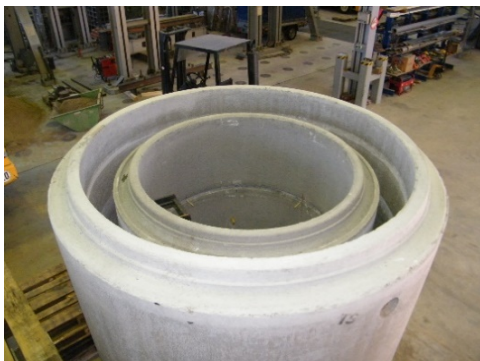
Bild 4 Einzelner Versuchsaufbau eines „Schacht-in-Schacht“-Probekörpers (links) und mit wassergefülltem Ringraum (rechts)
