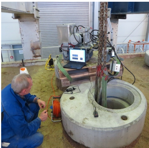
Bild 11 Einsatz des MAC-Systems im Großversuchsstand des IKT: Kontrolle des Tests an der Oberfläche (links); Komponenten im Schacht (rechts)
