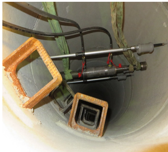
Bild 11 Einsatz des MAC-Systems im Großversuchsstand des IKT: Kontrolle des Tests an der Oberfläche (links); Komponenten im Schacht (rechts)
