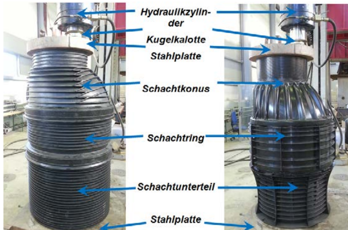
Bild 8 Versuchsaufbau unter dem 1MN-Portal zur Simulation von LKW-Überfahrten
