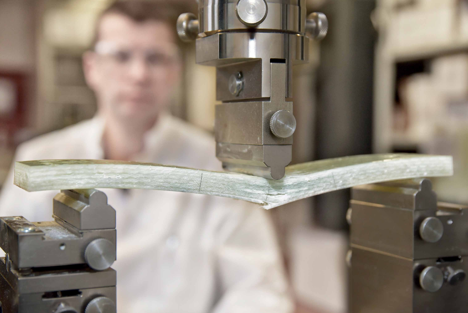
Sous pression : le vérificateur de l'IKT détermine la contrainte à la flexion lors de la rupture de l'échantillon de gaine.
