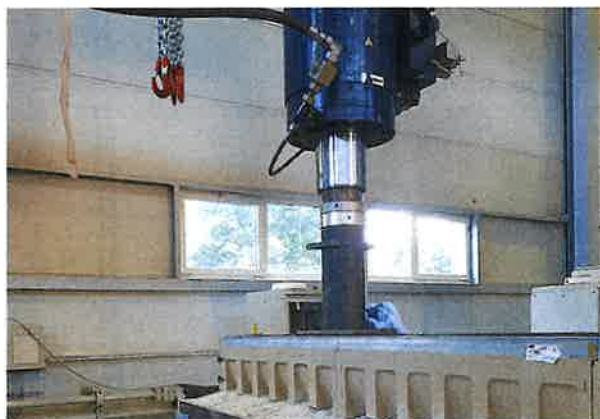
Abbildung 3: Prüfaufbau NW300 mit Stahlzarge.
