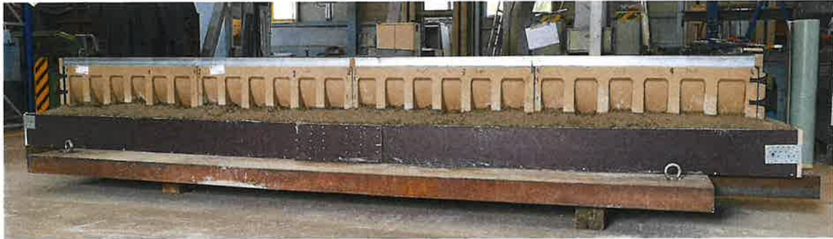
Abbildung 4: Eingebaute Rinne (4m) im Betonbett vor der zyklischen Belastung
