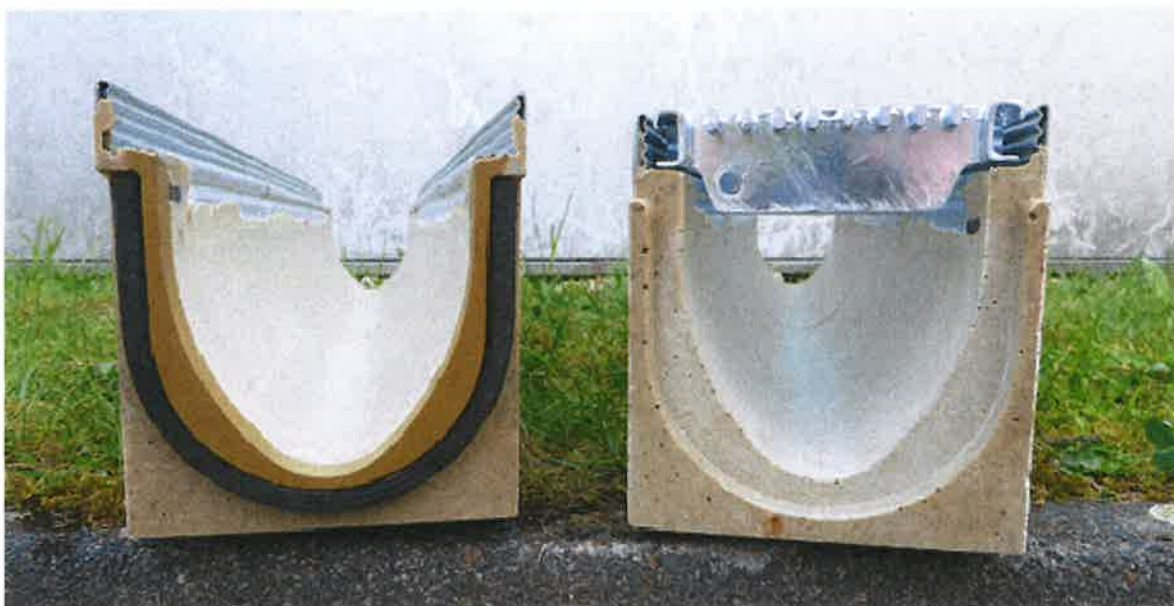
Abbildung 1: Stirnfläche der Rinne mit EPDM-Dichtungselement (links) und Gegenstück mit Dichtfläche (rechts)
