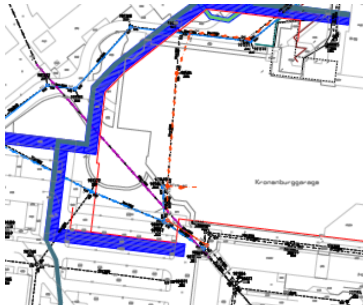
Abwasserdruckleitung „Vredenburg“ entfernen / neuen Ort
