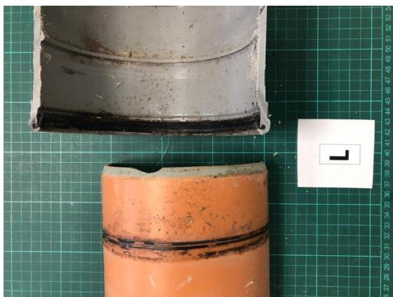
**Draufsicht - Labor - Feinwurzeln an Dichtungsband [Rechts]**
